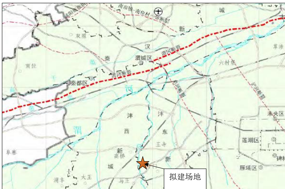
图 4.1-1 拟建场地与渭河断裂位置示意图
